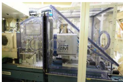
完全ヘリウム環境下での実験が可能なBL-1Aの回折計
