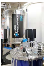
700 MHz + DNP超高感度プローブ
