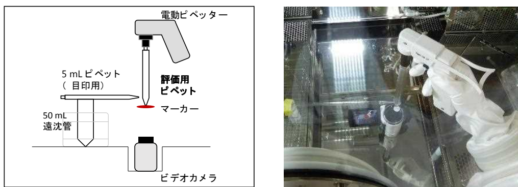
図 6 ピペット先端の振動評価方法
