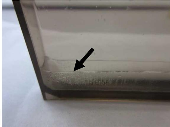
図 22 試薬ラックの溶解
