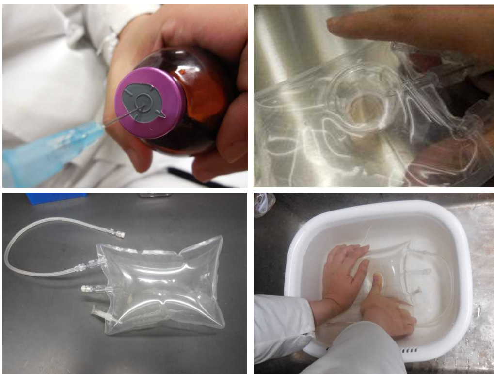
図4. ゴム栓の安全性試験
