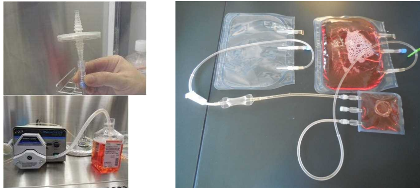
図3. 無菌充填とリーク試験・無菌試験
