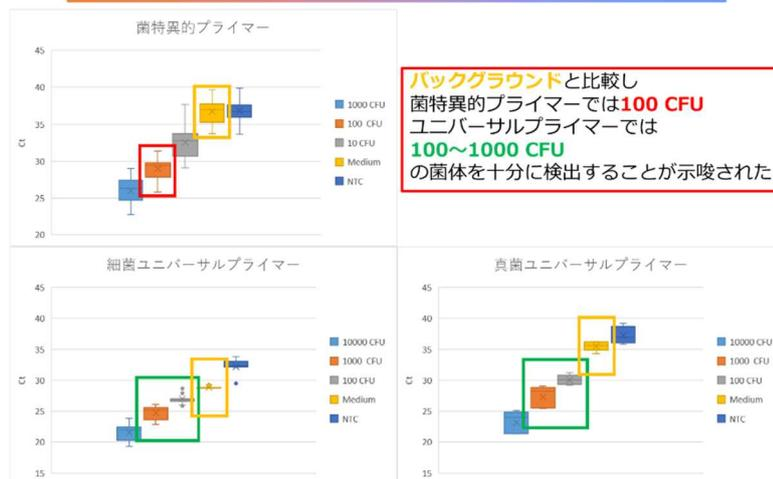
図6. 定量PCRによる各プライマーの感度検討結果
