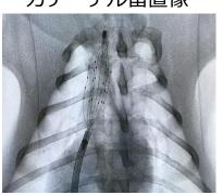
迷走神経刺激カテーテル装置。バスケット型刺激カテーテルと刺激装置で構成される。簡便な操作で留置でき、上大静脈に並走する迷走神経を安定的に長時間刺激することができる。現在、薬事承認を目指した非臨床試験を進行中。
