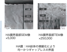
HA膜：HA粉体の微細化により均一かつギャップレスの界面
