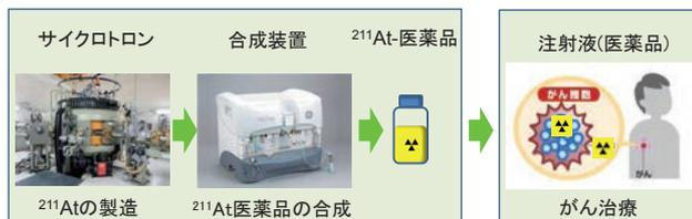
工場内のサイクロトロンで $^{211}\text{At}$ を製造し、 $^{211}\text{At}$ 医薬品として、出荷
