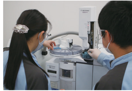
医薬品原材料中の残留溶媒を調査している様子。残留溶媒は医薬品の安全性に影響するため、その含有量を厳しく規定する。
