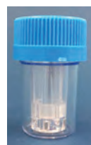
細胞分散ツール 高速回転するシリンダで細胞分散
