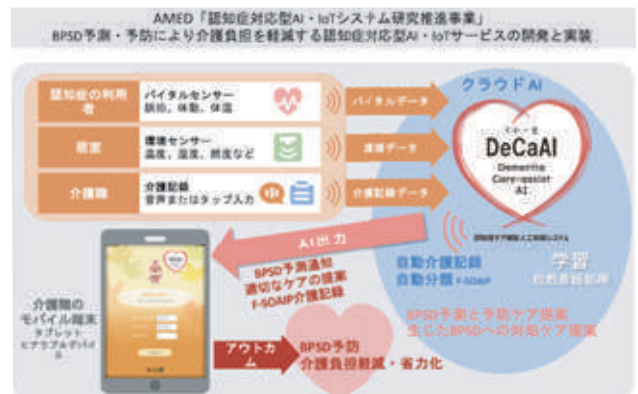
(図) 認知症対応型AI・IoTシステム概要
