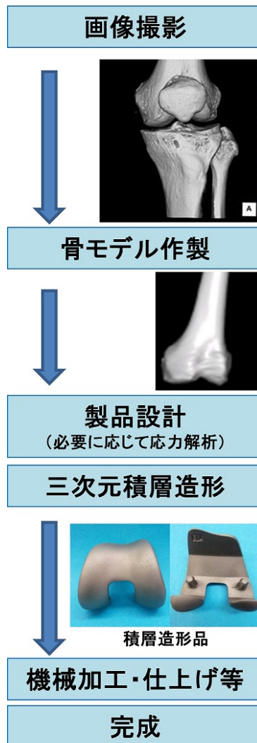
図5 人工膝関節大腿骨コンポーネントの三次元積層造形プロセスの例
