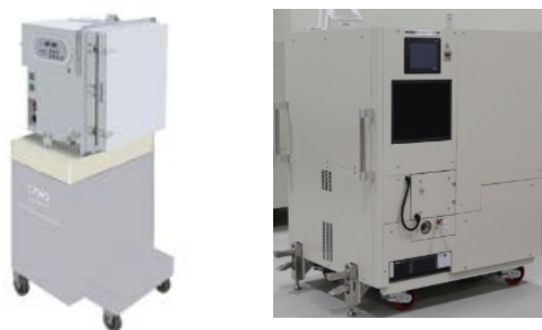
図 A1.6 : アイソレータ接続型インキュベータ
