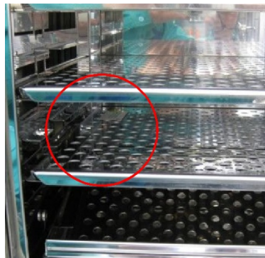
図 A4.1：除染サイクル開発時バイオロジカルインジケータの設置
