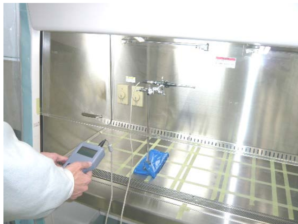
図 3.2 : 吹出し風速テスト
