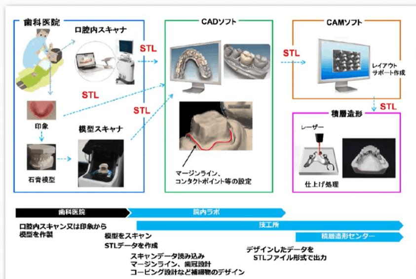
歯科補綴装置の三次元積層造形プロセス
