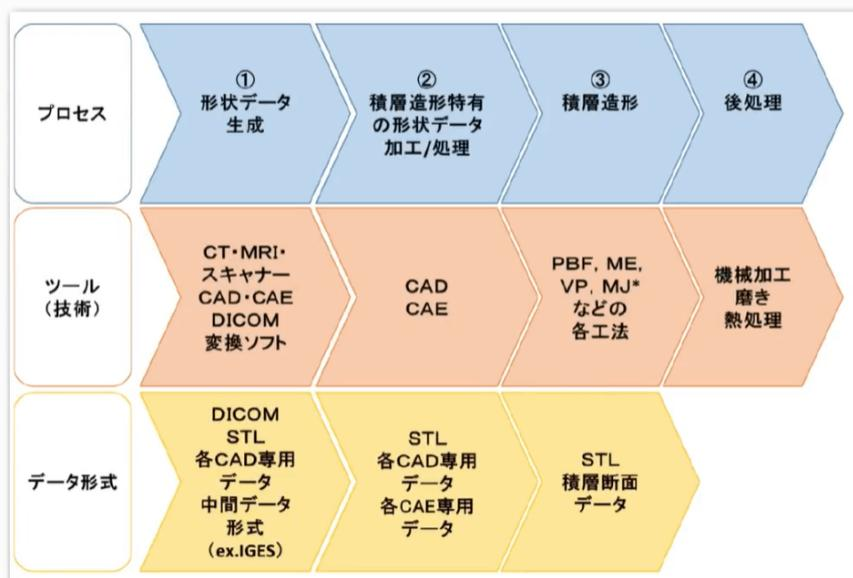
積層造形技術を用いた製品化のプロセス
