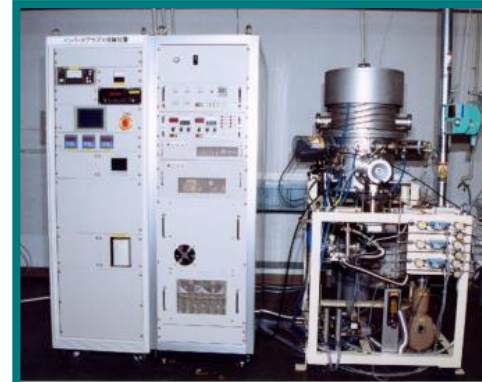
インバータープラズマ成膜装置 (φ4インチ、産総研関西センタ ー、ULVAC共同開発)
