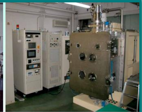
大面積プラズマ表面処理装置 (幅300 mm 連続処理)
