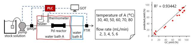
フロー送液技術の高度化においては、上記課題における送液を行うための送液システム開発を行った。脈動を抑制するポンプを開発し、上記の検討、とくに数時間程度の連続運転に活用した。インライン圧力計および流量計で送液の様子をモニタリングしたところ、大きな脈動なく送液が可能であることがわかった。加えてこれらインラインモニタリングによる反応系の監視、すなわち PAT が可能であることが実証できた。
