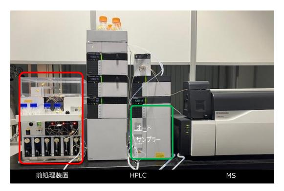
円盤形による制御方式とし、前処理後の分析を行う高速液体クロマトグラフ質量分析計 (LC/MS) と連動する前処理装置を完成させた。
