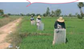
チャンパー法による水田から排出されるメタンのサンプリング状況
