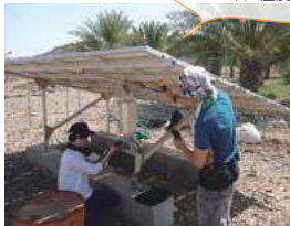
ディキル篤農家農園のソーラーポンピングシステムの効率解析・発電量とパネル温度の調査
