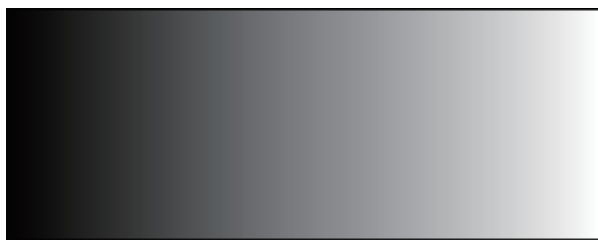
図 2-5 上記画像は幅 256 ピクセルであり、輝度 0 (真っ黒) から輝度 255 (真っ白) まで 1 輝度ずつ遷移している。しかし、人間の視覚 (および印刷) により、両端部分の定量性が失われている
