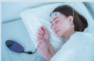
睡眠中の脳波を測定する装置
