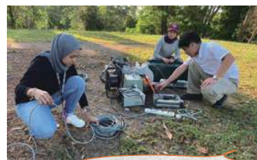
観測装置設置場所選定のため 電波環境の予備測定を行っている様子
