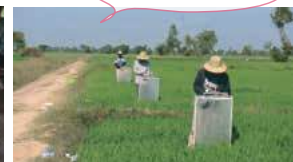
チャンパー法による水田から 排出されるメタンの サンプリング状況
