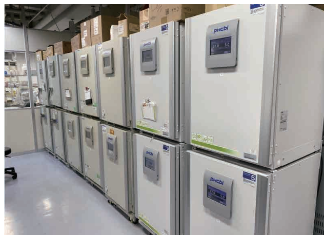
図2. 研究室の培養室にはたくさんの培養機器(インキュベーター)があり、多くの抗体生産を実施。
