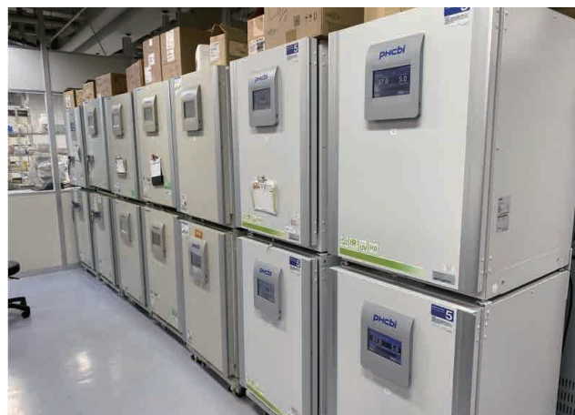
図2. 研究室の培養室にはたくさんの培養機器(インキュベーター)があり、多くの抗体生産を実施。
