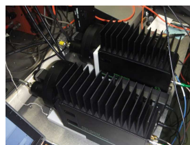
図2 小型時間分解型蛍光イメージング計測システム
